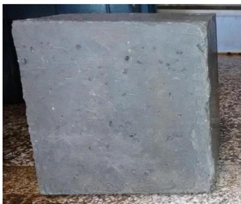
(a) Corpo de prova cúbico
