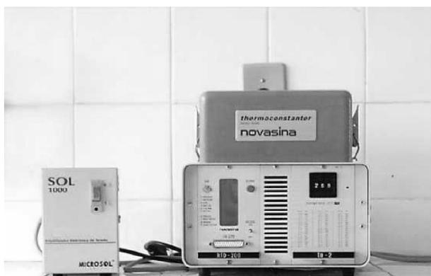
Figura 1 – Equipamento Thermoconstanter Novasina TH-02, utilizado para determinação da atividade de água.
