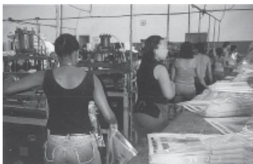
**Figura 3.** Máquinas de valvulado paralelas. Visualizam-se as trabalhadoras que ocupam o posto de trabalho no qual “se puxa” a embalagem sob a prensa.
