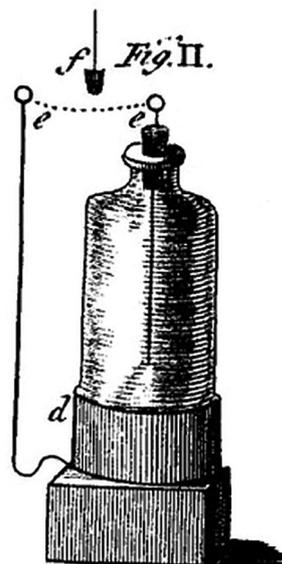
**Figura 1:** Esquema de uma das garrafas utilizadas por Franklin, demonstrando o experimento de restauração de equilíbrio de fluido elétrico. Fonte: [5, plate 1].
