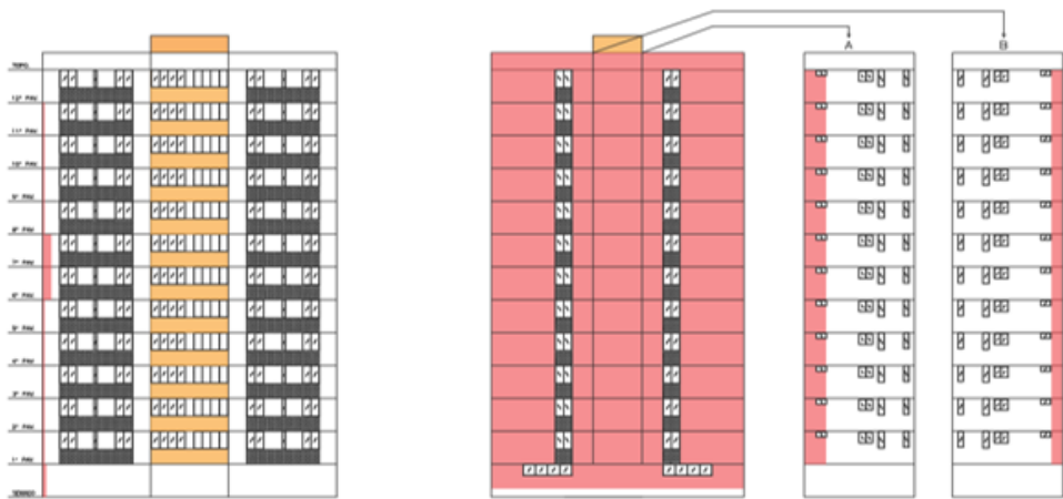
Figura 4 - Mapeamento das manchas vermelhas
