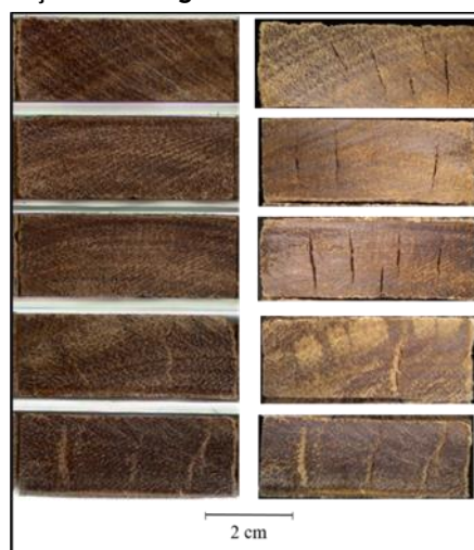
Figura 4 - Amostras de Corymbia citriodora modificados termicamente a 160 °C antes (esquerda) e após (direita) o processo de interação com a água
