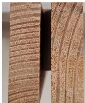
Figura 1 - Amostras cortadas na orientação denominada radial (a esquerda) e tangencial (a direita)
