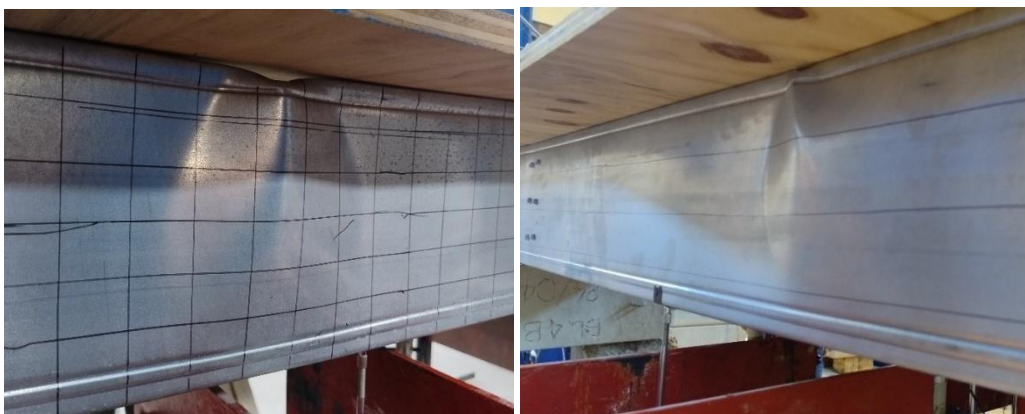
Figura 17 - Flambagem local dos perfis de L-4 CP-A (esquerda) e L-2 CP-B (direita)
