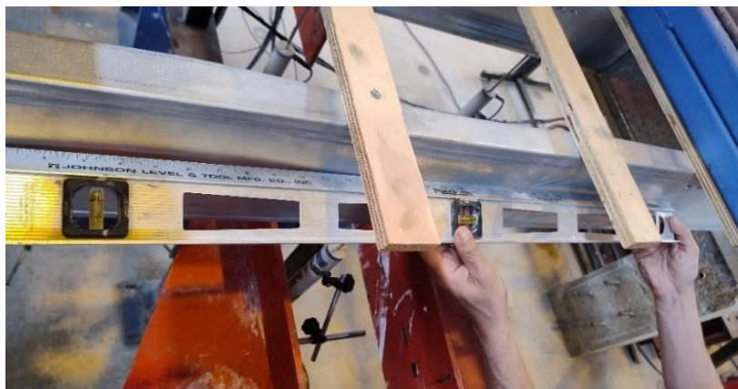
Figura 14 - Flambagem distorcional nos perfis (laje L-1, CP-B)
