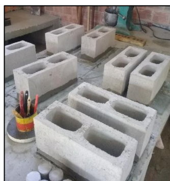
(a) Em execução do capeamento
