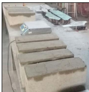
(b) Em execução do capeamento
