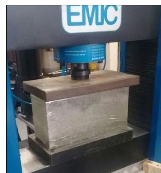
(c) Submetido ao ensaio de resistência à compressão
