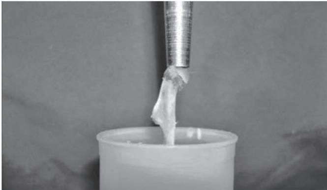
**Figura 2** – Detalhe do corpo de prova em repouso e do cutelo de aplicação de carga, posicionado axialmente à cabeça umeral.
