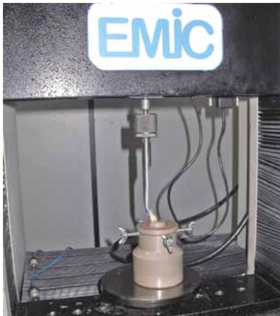
FIGURA 1 - Dispositivo confeccionado para que mantivesse o corpo de prova estável durante o ensaio.
