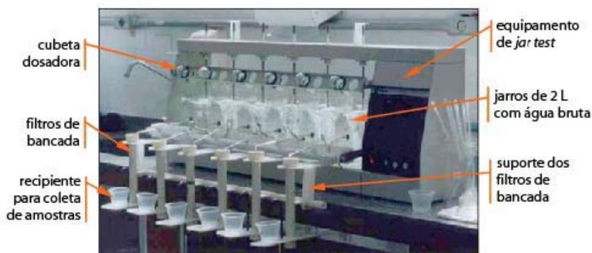
Figura 1 - Equipamento de *jar test* com os filtros de bancada acoplados
