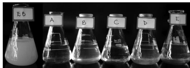
Figura 2. Fotografia em fundo escuro das amostras do efluente bruto (EB) e dos efluentes tratados referentes a cada ensaio realizado
