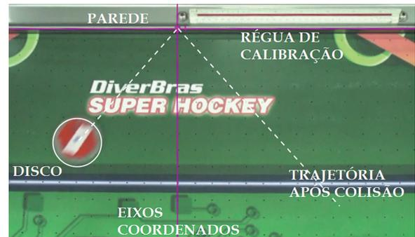
**Figura 8:** Colisão oblíqua de um disco com uma fronteira rígida, sobre uma superfície sem atrito.
