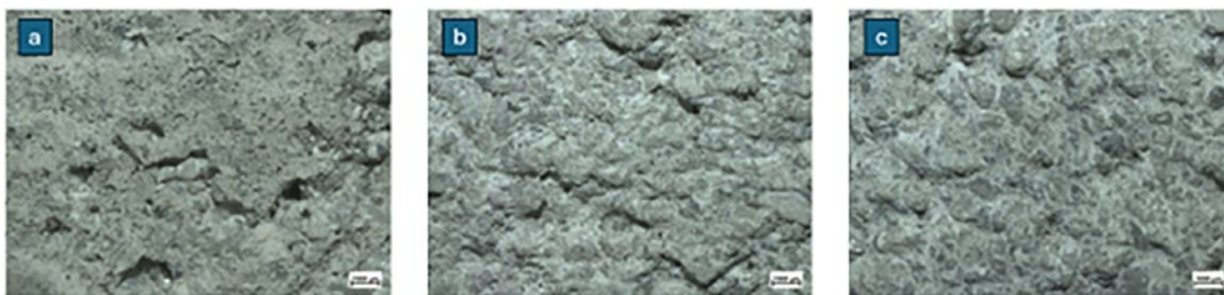
Figura 2: Imagens do estereoscópio das superfícies do agregado de concreto reciclado com (a) superfície natural; (b) superfície pós-tratamento mecânico e (c) rugosidade pós lixamento simples.
