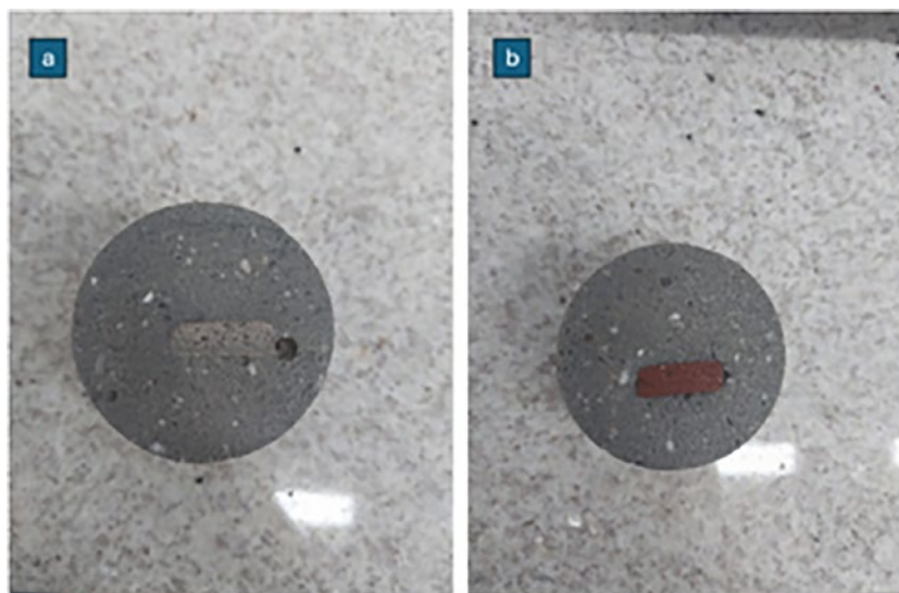
Figura 4: Corpo de prova de argamassa seccionado transversalmente com agregado reciclado de concreto (a) e tijolo cerâmico (b).
