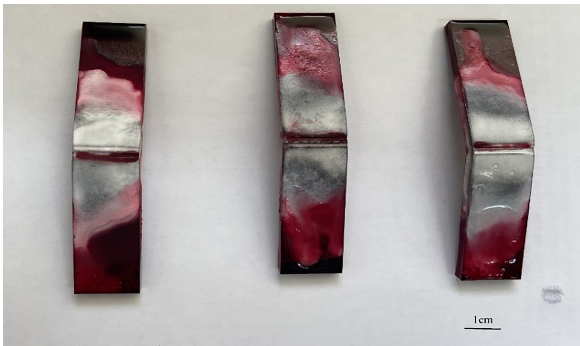
Figura 14: Ensaio de líquido penetrante nas amostras pós ensaio de flexão apresentados na Figura 12.
