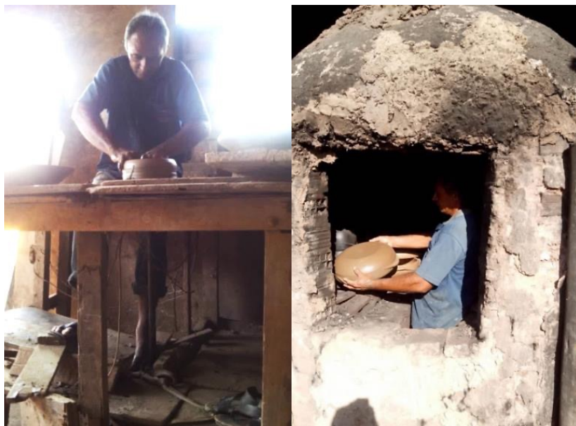
Figura 3. Artesão de Guarapari – etapas de modelagem (torno) e queima (forno)
