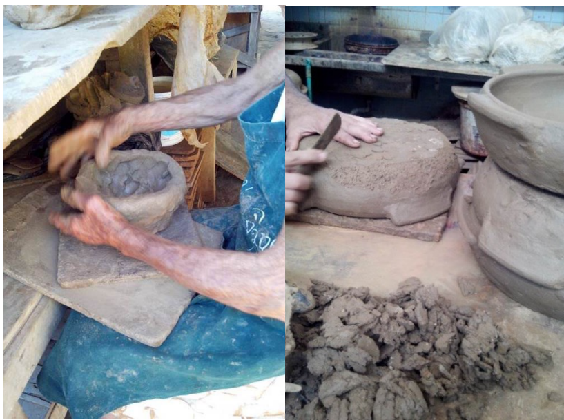
Figura 4. Processo produtivo em Goiabeiras – etapas de modelagem e raspagem
