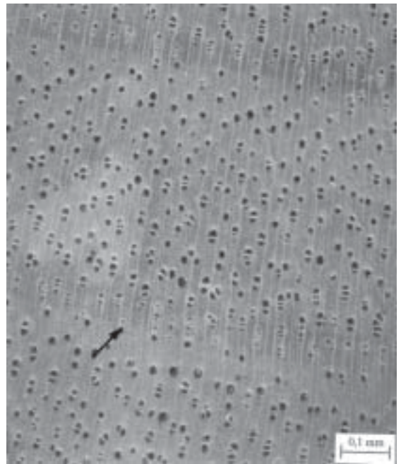
Figura 3. Fotomicrografia do lenho de Terminalia ivorensis em seção transversal. Camadas de crescimento delimitadas principalmente pelo espessamento da parede das fibras.
