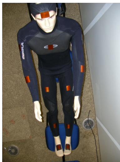
Figura 3 - Manequim com sensores aquecidos
