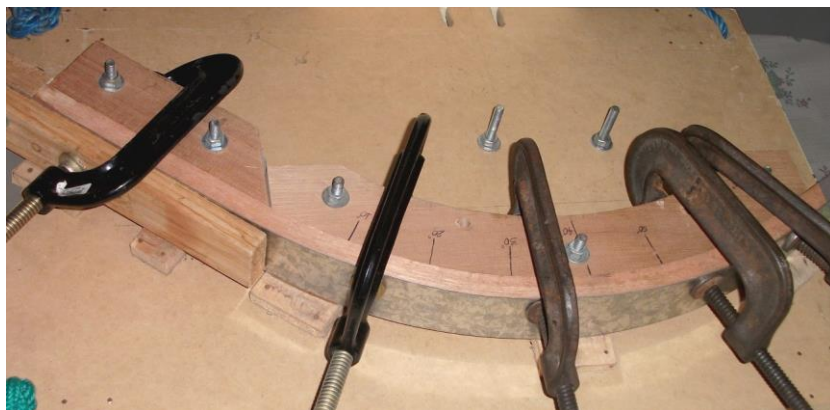
Figura 2 - Corpo de prova vergado fixo com o auxílio de grampos junto ao dispositivo
