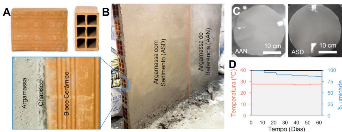
Figura 2 - (a) Bloco cerâmico de vedação; (b) painel com argamassa aplicada; (c) consistência e (d) condições de temperatura e umidade ao longo do tempo do painel até a idade de ensaio
