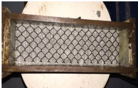
Figura 5 - Tela inserida sobre a primeira camada de argamassa, localizada a um terço da altura do corpo de prova prismático
