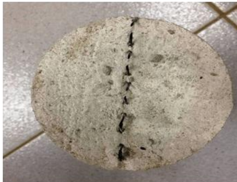
Figura 4 - Detalhe da posição da tela para ensaio de compressão diametral
