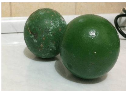
Figura 10 - Esfera maciça do ensaio de impacto
