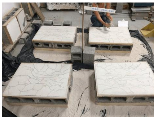
(a) Alvenaria sobre uma camada de areia
