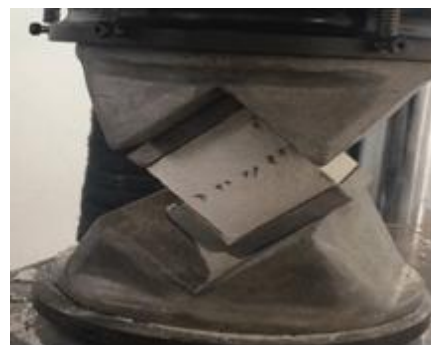
(b) Detalhe do ensaio de cisalhamento
