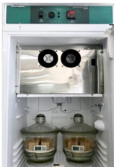
Figura 3 - Câmara climática (controle da temperatura) e dessecadores com corpos de prova (controle da umidade com soluções salinas saturadas)
