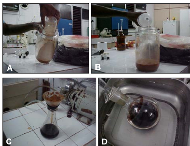
FIGURA 1 – Fases de preparação do extrato. Nota: A – Pó; B – Diluição; C – Filtração; D – Evaporação
