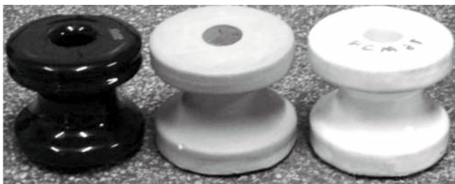
Figura 11: Isoladores obtidos a partir do resíduo. [Figure 11: Insulators obtained by using waste.]
