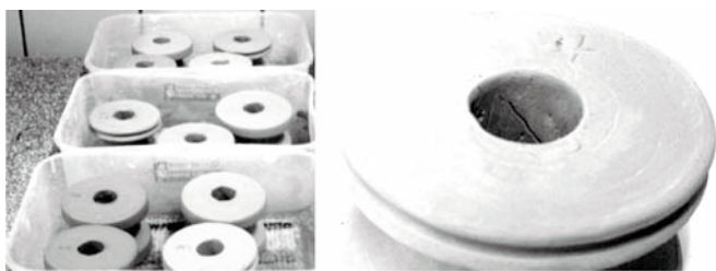
Figura 8: (a) Secagem das amostras; (b) trinca de secagem. [Figure 8: (a) Drying process of samples; (b) cracks due to the drying process.]
