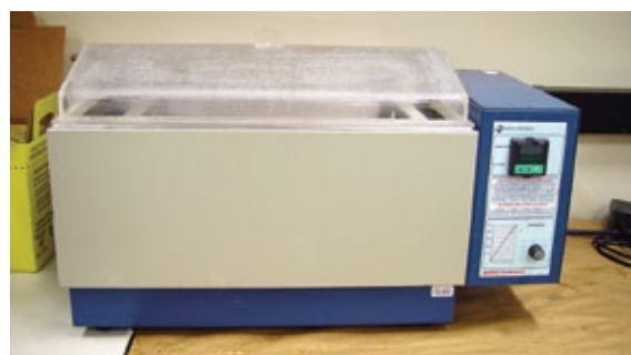
FIGURA 5 - Equipamento para banho Dubnoff com agitação e controle da temperatura.
