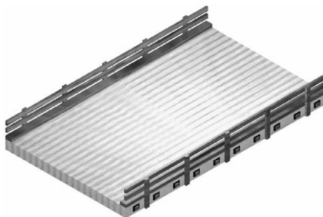
FIGURA 1. Desenho esquemático de ponte de madeira laminada protendida.
