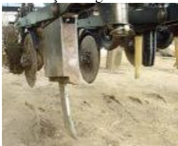
FIGURA 3. Dispositivo de medição com haste e ponteira montado na linha da semeadora. The measuring device with shank and tip mounted on the planter row.
