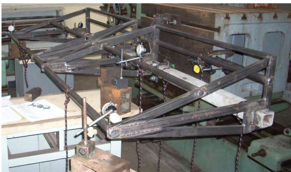
FIGURA 4. Montagem do ensaio – posicionamento dos relógios no chassi e dos cabos para aplicar os carregamentos. Mounting the test - positioning of the dial indicators in the frame and cables to apply the loads.
