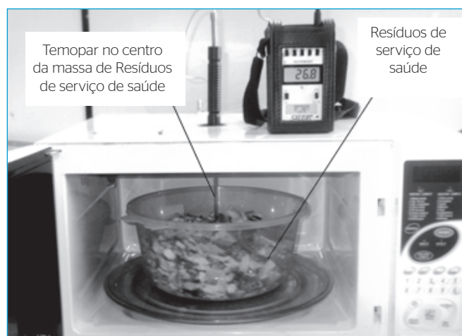
Figura 1 - Forno de micro-ondas com indicação do resíduo e do termopar.
