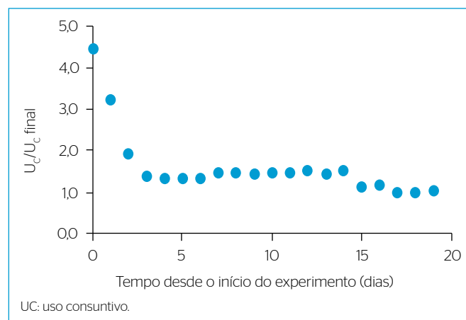
Figura 3 - Relação entre a razão do uso consuntivo por seu valor final e o tempo do experimento em um canteiro controle no município de Madalena, Ceará (2011).
