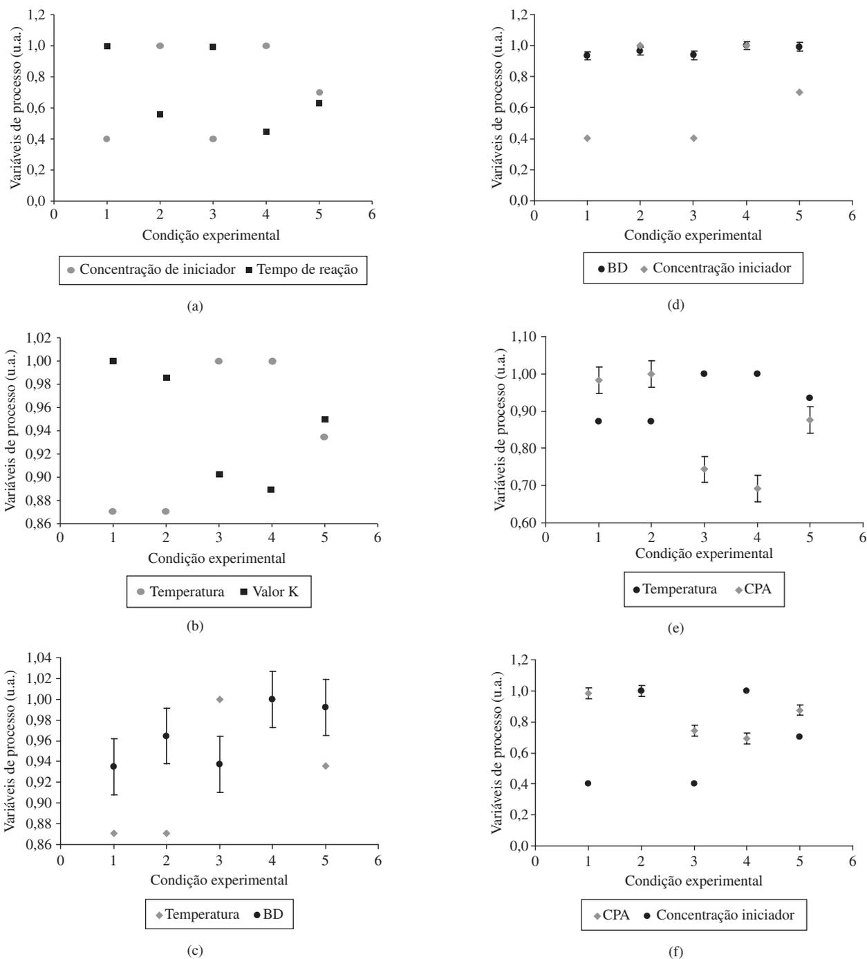
**Figura 3.** Avaliação das condições experimentais. a) Influência da concentração de iniciador sobre o tempo de reação; b) influência da temperatura de reação sobre o valor K da resina; c) influência da temperatura de reação sobre a BD; d) influência da concentração de iniciador sobre a BD; e) influência da temperatura de reação o CPA; e f) influência da concentração de iniciador sobre o CPA.
