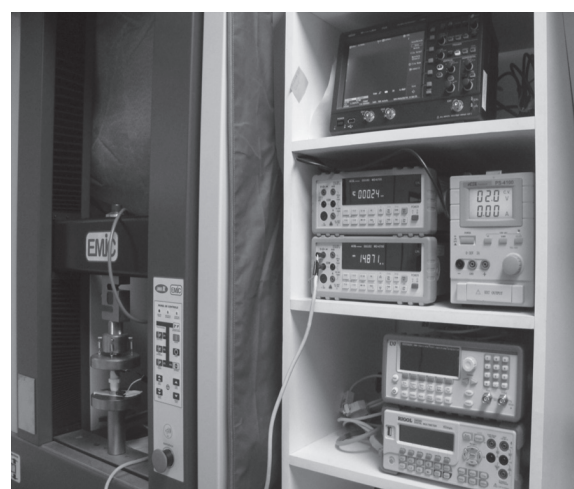
Figura 1. Esquema (a) e foto (b) do sistema usado para medidas de sensibilidade à compressão.
