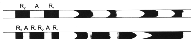
Figura 2. Modelo da dispersão mútua na interface das alíquotas das soluções. Em a, A, R_1 e R_2 = alíquotas da solução da amostra, molibdato de amônio e ácido ascórbico, respectivamente, representando um ciclo de amostragem. Em b, é representado dois ciclos de amostragem efetuados na mesma sequência de a, sendo o volume de cada alíquota metade do volume do caso anterior.
