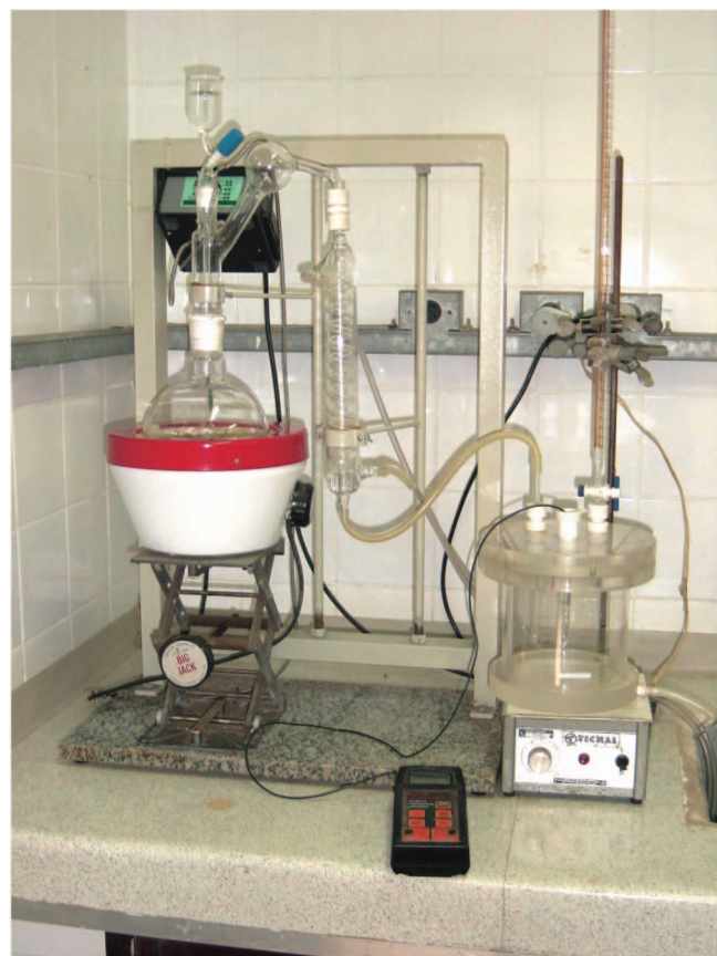
Figura 3. Sistema de produção de (^{15}\text{NH}_4)_2^{34}\text{SO}_4 a partir do (^{15}\text{NH}_4)_2\text{SO}_4 e \text{H}_2^{34}\text{SO}_4
