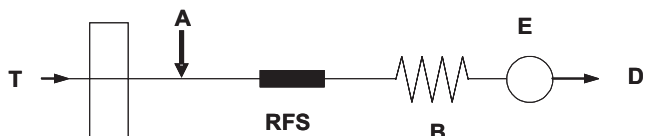
Figura 2. Diagrama esquemático do sistema de análise por injeção em fluxo para determinação turbidimétrica de dipirona. T, solução transportadora (NaOH 0,01 mol L -1 ) com vazão de 2,0 mL min -1 ; A, soluções de referência ou amostra (alça de amostragem = 375 µL); RFS, reator em fase sólida contendo AgCl (8,5 cm x 2,0 mm d.i.); B, bobina reacional (50 cm); E, espectrofotômetro (425 nm); D, descarte
