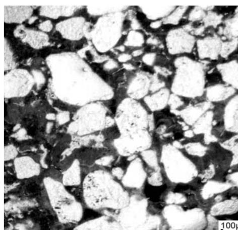
Figura 5. Estrutura de base porfirogrânica com porosidade cavitária e fissuras finas no horizonte BA do perfil 2.
