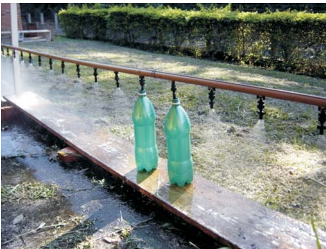
Figura 1. Barra de pulverização construída para as avaliações
