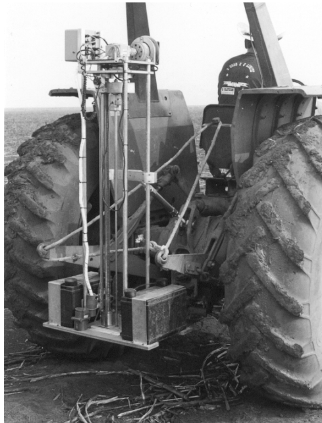
Figura 2. Penetrógrafo eletrônico montado no trator
