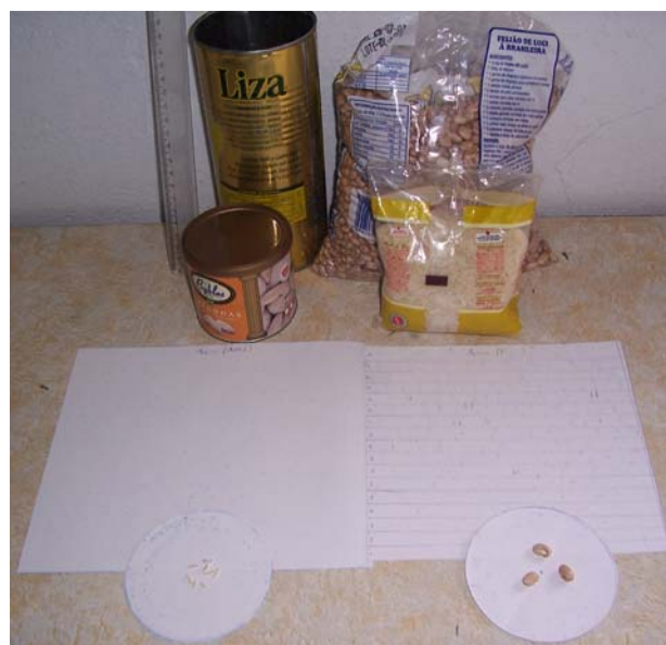
Figura 1 - Fotografia mostra os materiais usados nos experimentos e nossos resultados quando a lata foi preenchida com arroz (à esquerda) e com feijão (à direita). Superfície lateral da lata acima e fundo abaixo.
