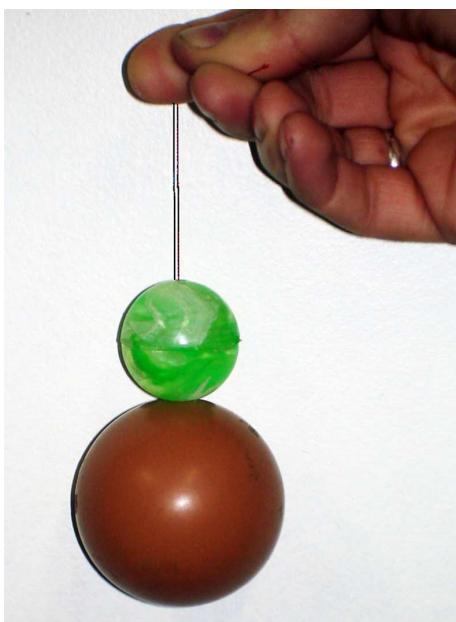
Figura 7 - Dispositivo para demonstração do 'efeito estilingue' em sala de aula.
