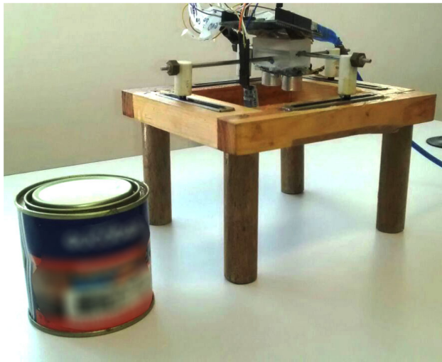
Figura 14: Lata de verniz utilizada no segundo experimento de obtenção de imagem ultrassônica.
