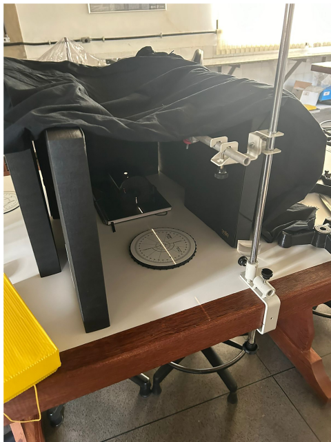
Figura 1: Montagem do experimento para filmagem. O smartphone foi posicionado embaixo da cobertura escura, paralelo ao plano do goniômetro.
