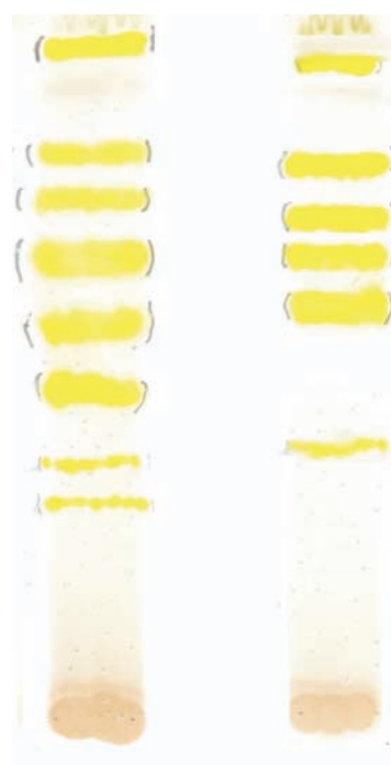
Figura 7. Perfil cromatográfico, obtido por CCD, dos extratos etanólico de D. elliptica e hidroetanólico de D. rugosa . Eluente: acetato de etila/ácido fórmico/ácido acético/água (100:11:11:27). Revelador: cloreto de alumínio a 5% em etanol.
