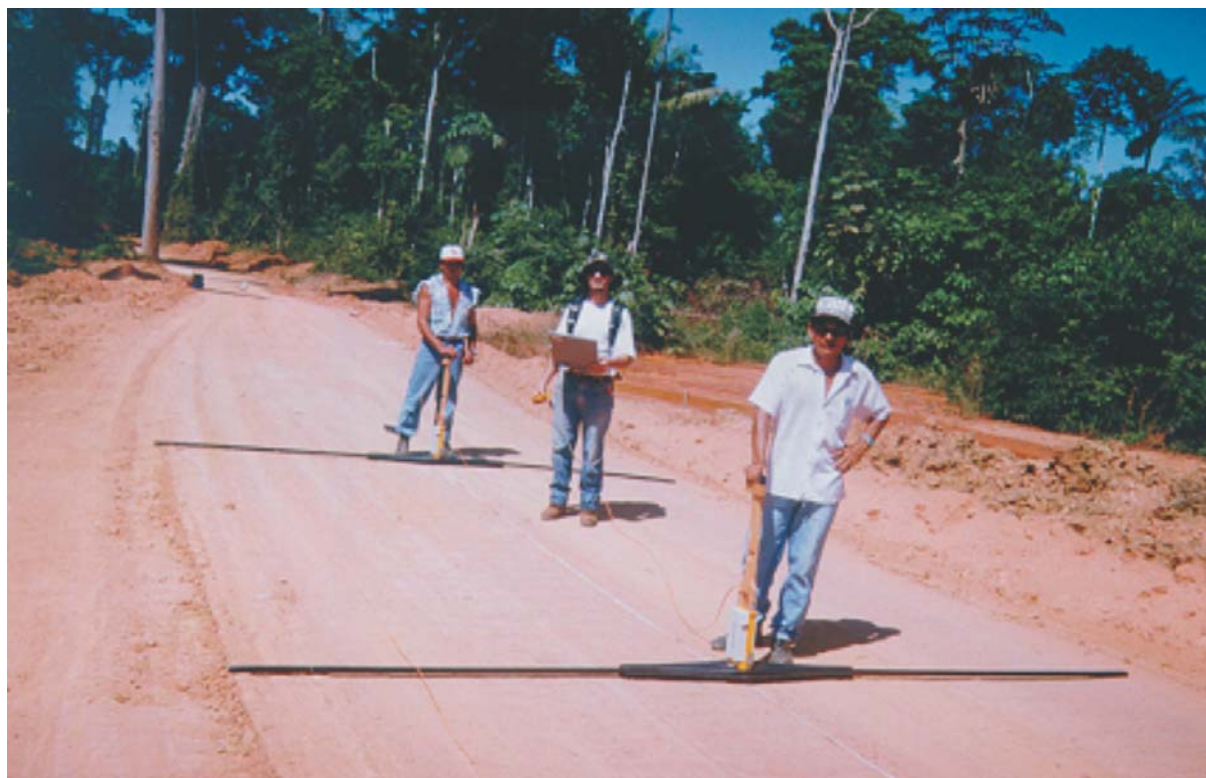
Figura 5 – Aquisição dos dados GPR com as antenas de 25 MHz.
