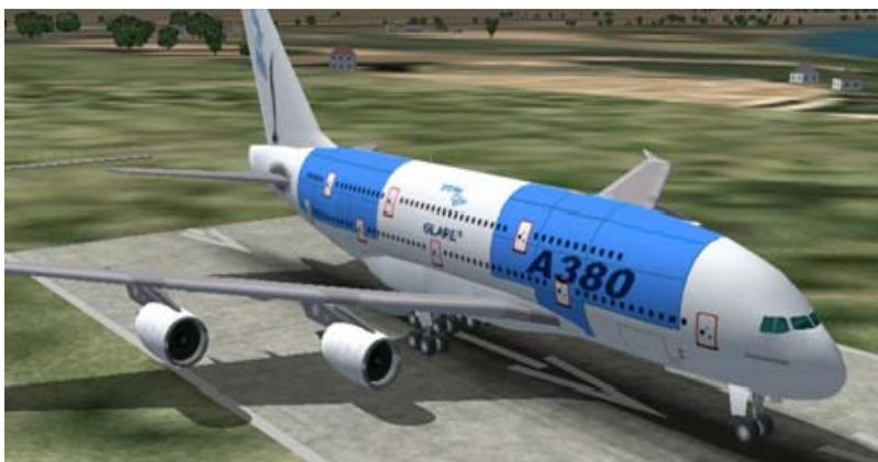
**Figura 2:** Fuselagem superior da aeronave Airbus A380, confeccionada com Glare.
