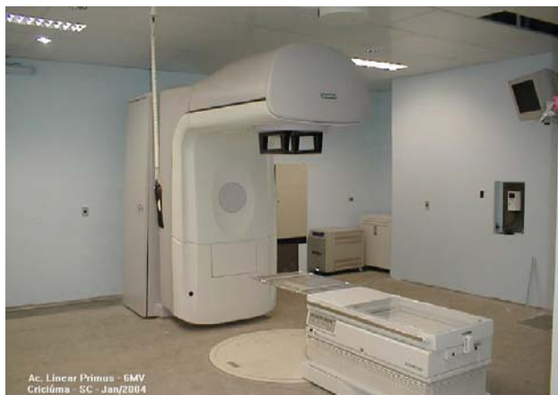
Figura 4: Acelerador Linear modelo Primus marca Siemens com energia de fótons 6 MV do Serviço de Radioterapia do Hospital São José de Criciúma / SC.
