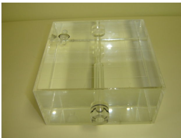
Figura 5: Phantom de acrílico com água no interior simulando corpo humano para irradiação das amostras submetidas ao efeito da radiação ionizante
