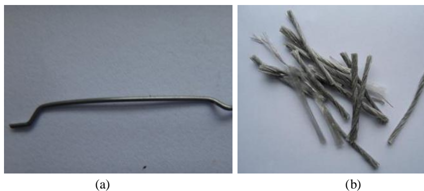
Figura 5: a) Fibra de aço utilizada; b) Fibra de polipropileno utilizada.
