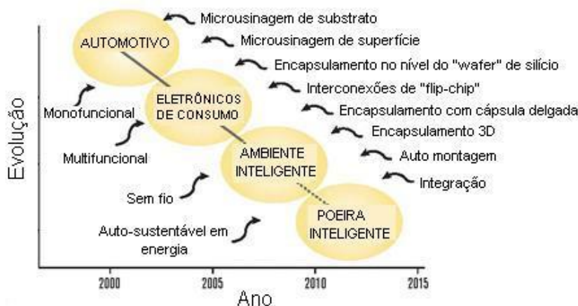
Figura 8: Avanços nos processos de fabricação de sensores MEMS e o surgimento de novas aplicações [22].
