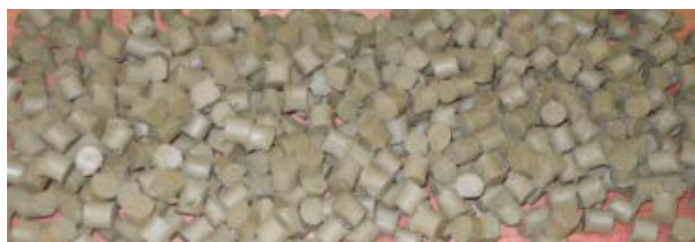
Figura 1: Agregados leves de argila calcinada produzidos na pesquisa
