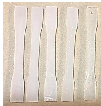
Figura 2: Rectificado de especímenes de resina epóxica con lijas a diferentes grados de orientación.
