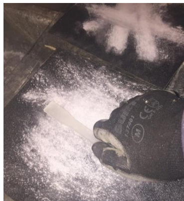
Figura 2: Rectificado de especímenes de resina epóxica con lijas a diferentes grados de orientación.
