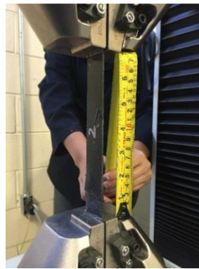
Figura 9: Probeta de material compuesto, sometida a prueba de tensión.
