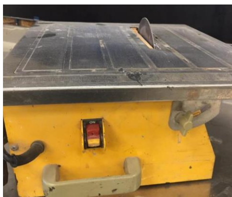
Figura 7: Cortador de disco de acero, utilizado para obtener probetas de material compuesto estandarizadas por mediadas de ASTM D3039
