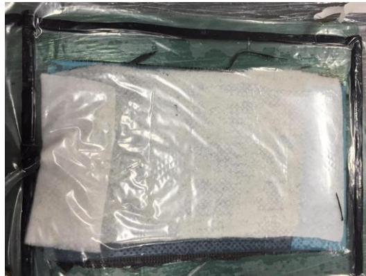
Figura 4: Proceso de manufactura al vacío para caracterización de material compuesto.
