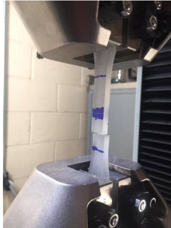
Figura 8: Probeta Tipo I sometida a prueba de tensión.
